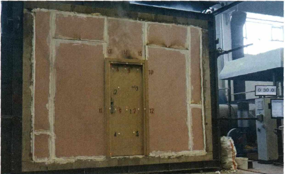
Şekil 19. Deneyin 30. Dakikasında Deney Numunesi ve İlişkili Yapı
