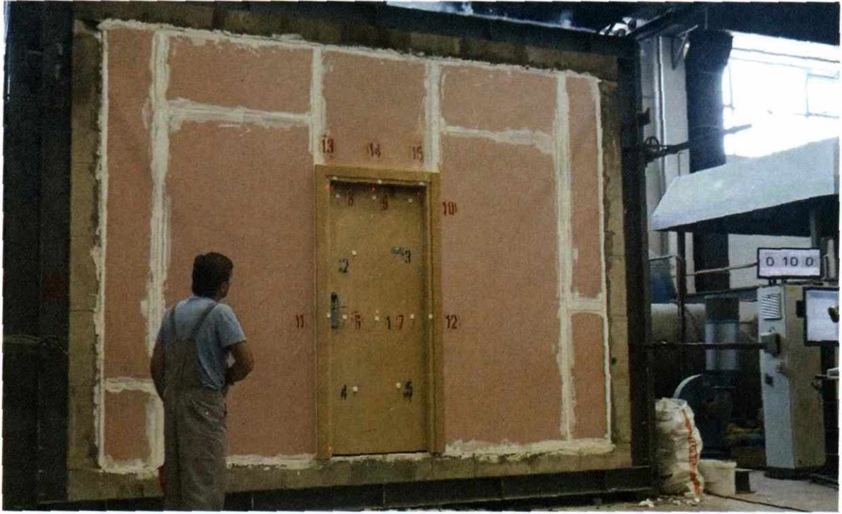
Şekil 18. Deneyin 10. Dakikasında Deney Numunesi ve İlişkili Yapı
